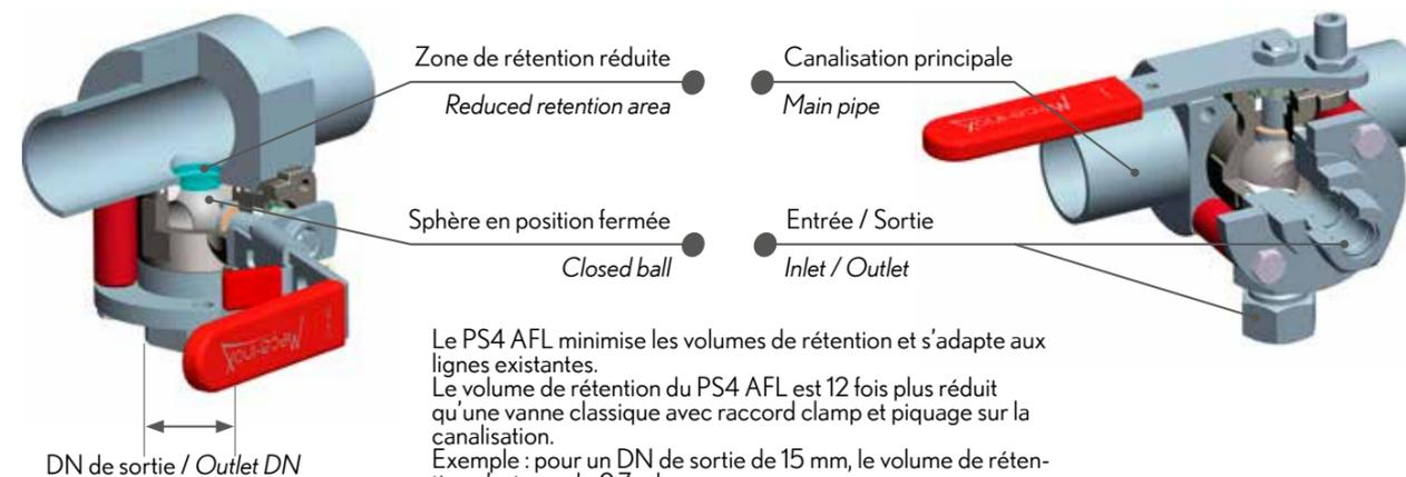
Le PS4 AFL minimise les volumes de rétention et s'adapte aux lignes existantes. Le volume de rétention du PS4 AFL est 12 fois plus réduit qu'une vanne classique avec raccord clamp et piquage sur la canalisation. Exemple : pour un DN de sortie de 15 mm, le volume de rétention n'est que de 0,7 ml.
